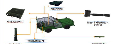
TICN 증폭기 설치
