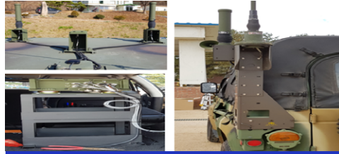
군용차량 브라켓 설치
